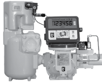
Débitmètre M7 avec enregistreur électronique LectroCount LCR-II, optique Éliminateur d'air, filtre haute capacité et vanne E-7
