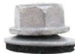
Aperto Insuficiente Provável em causar vazamento sob a vedação e ao redor do fixador.
