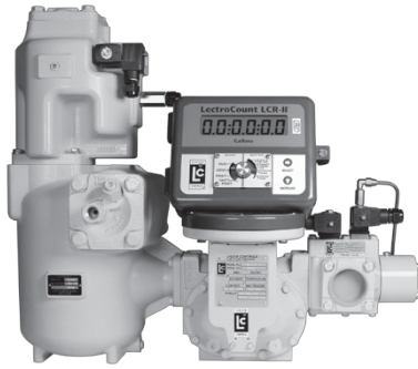
Contador M7 con contador electrónico LectroCount LCR-II, eliminador óptico de aire, filtro de alta capacidad y válvula E-7
