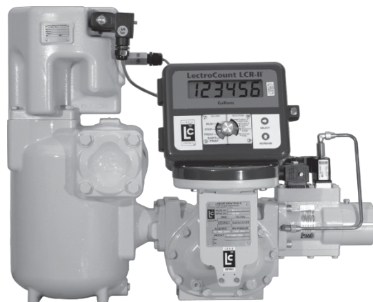
Contador M-10 con registrador electrónico LectroCount LCR-II, eliminador óptico de aire, filtro de alta capacidad y válvula E-7.
