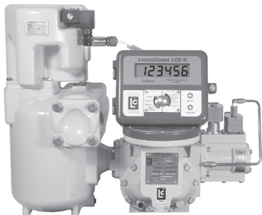
Contador M-10 con contador electrónico LectroCount LCR-II, eliminador óptico de aire, filtro de alta capacidad y válvula E-7.
