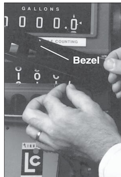
Figura 13a: Desmontaje del bisel
